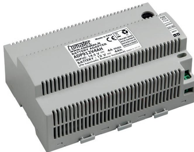
Mit dem Akkumulator »ADP9« realisieren Sie in Verbindung mit unserem 12 V Netzteil eine kostengünstige Notstromversorgung – beispielsweise für den EIB**PORT**. Im Falle eines Stromausfalls oder einer Spannungsunterbrechung wird so für mindestens 6 Stunden (bei einer Belastung von 5 W) die Versorgung mit Strom sichergestellt. Der Akku ist für die Hutschienenmontage konzipiert und besitzt eine integrierte Sicherung, um die Batterie zu schützen.
